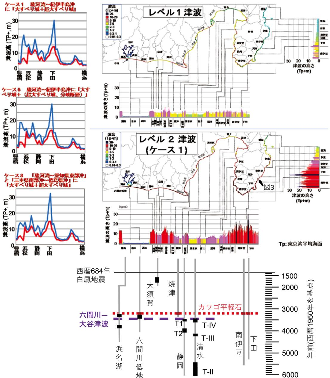
図2 静岡県におけるレベル1とレベル2の津波の想定津波高 (m) と4000年間の津波堆積物の分布. Kitamura (2016) を改変.
