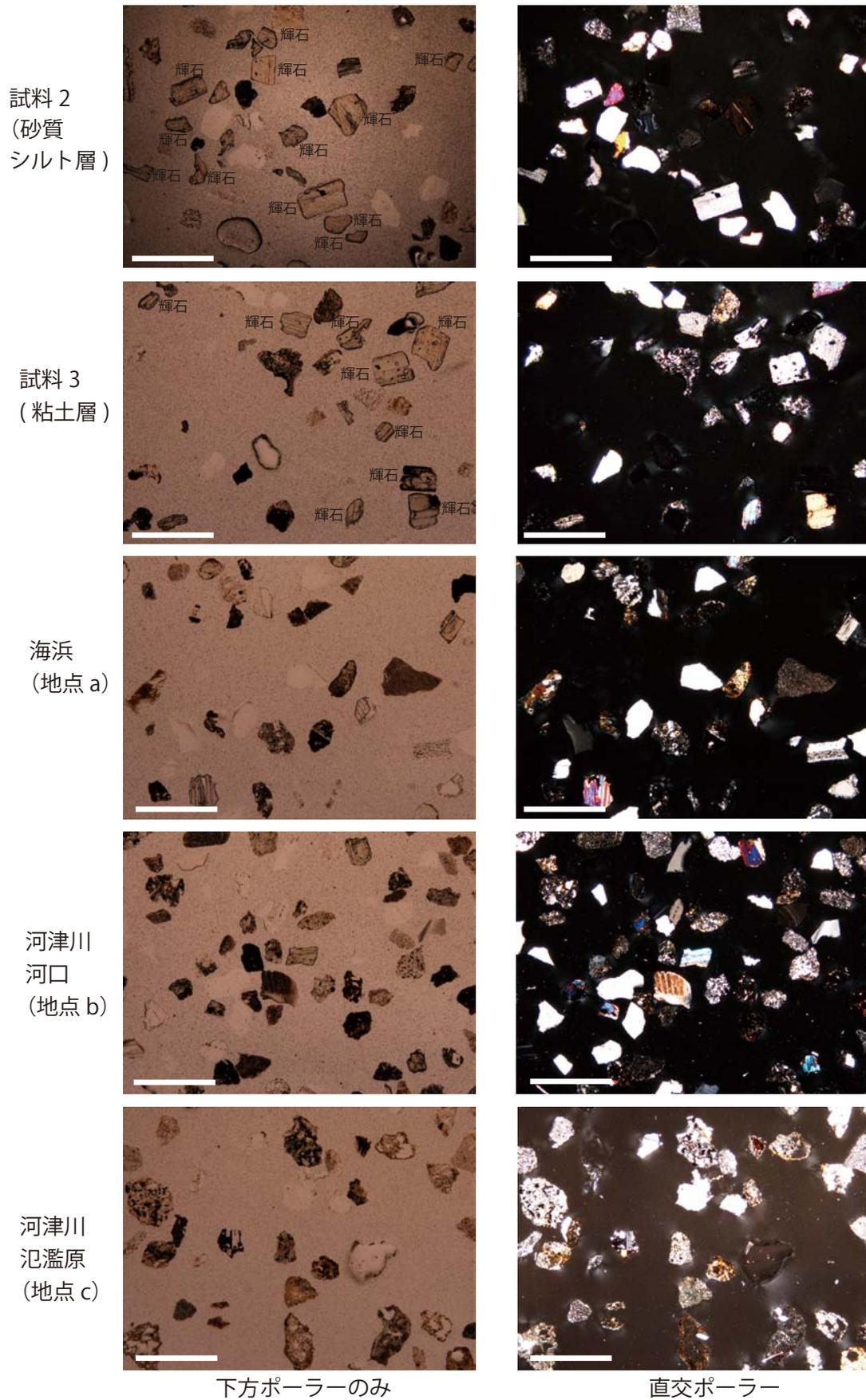
図 10 各試料の中粒砂サイズ (粒径0.25~0.50mm) の粒子の薄片写真。スケールは1mm.
