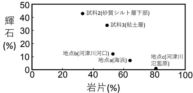
図11 各試料の粒径0.25～0.50mmの粒子における岩片と輝石の占有率
